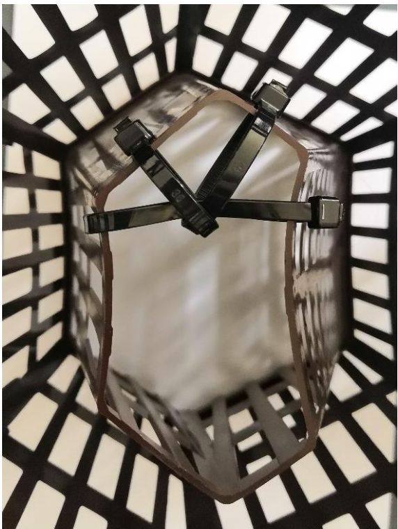
Abb. 8: Kehllöpfung der Reuse "Pirat" mit der Modifikation 1 (Freese 2023).
