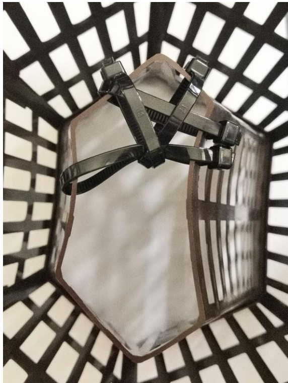
Abb. 9: Kehllöpfung der Reuse "Pirat" mit der Modifikation 2 (Freese 2023).
